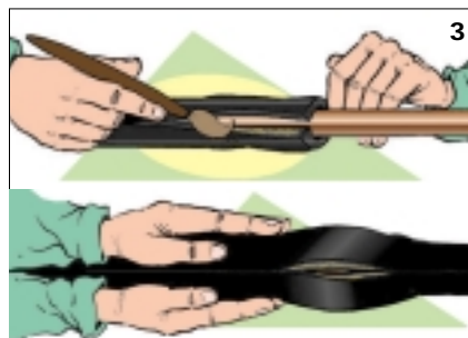
Kleber auf Oberflächen auftragen und verschließen
