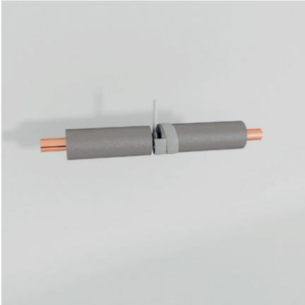
Isolierung bis an die Schelle beidseitig anbringen und mit CLIMAFLEX® PE-Selbstklebeband bis auf Isolierhöhe umwickeln.
