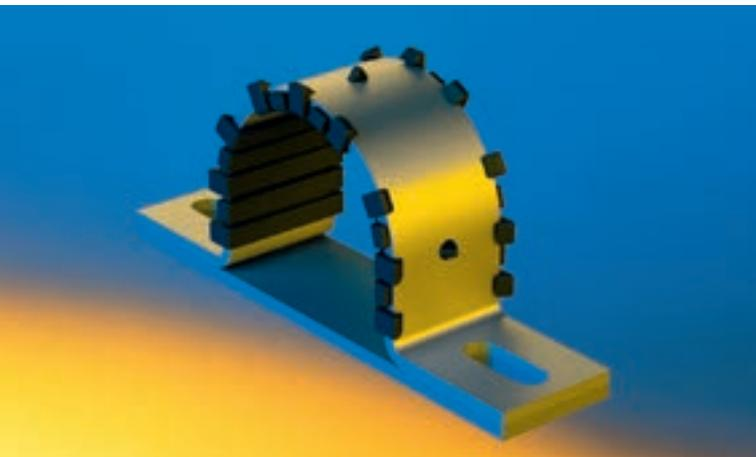
Die Bügelschelle RUC I wird als Führungslager zur Montage auf Framo Trägerprofilen, Montage-schienen 41 und Stahlträgern (H-, I- und Doppel-U) für die Halterung kaltgehender Rohrleitungen eingesetzt. Als Alternative zu Rundstahlbügeln bietet diese Bügelschelle eine breite Anlagefläche. Gleitplatte und Kunststoffgleiter dienen als Kontaktschutz zwischen Rohr und Unterkonstruktion.
