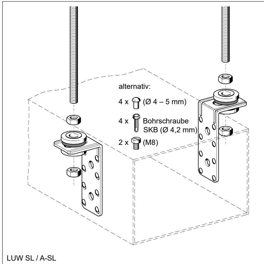
Befestigung des Lüftungswinkels am Kanal in der Regel mit 4 Stahlrieten oder Blechschrauben (SCR L).
